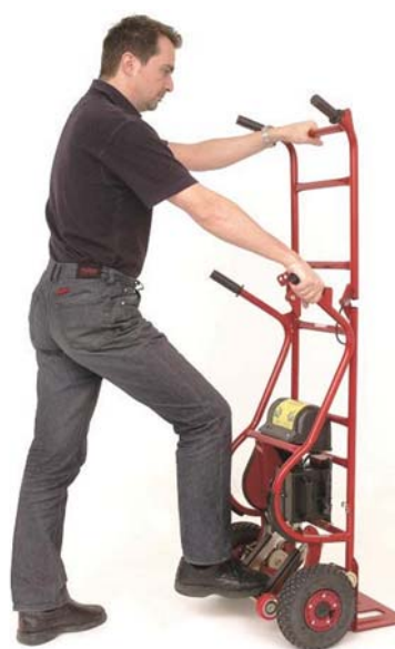
For at lette løft af tunge emner, sættes foden på akslen med støttehjulene.
